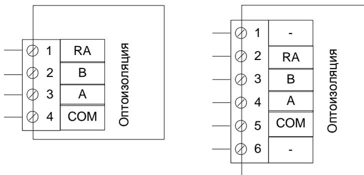
Подключение датчиков ТС к порту В
