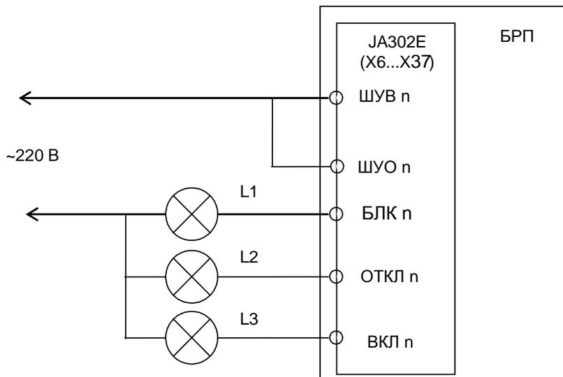
Рисунок 8 – Схема проверки каналов ТУ блока
