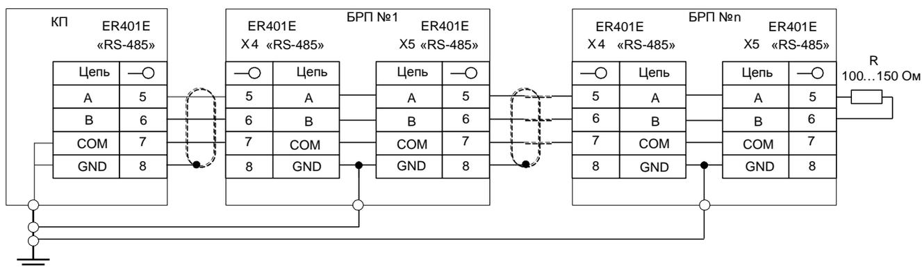
Рисунок 6 – Схема подключения блока к устройству КП
