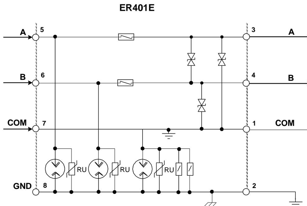
Рисунок 7 – Схема линейного узла стыка связи RS-485
