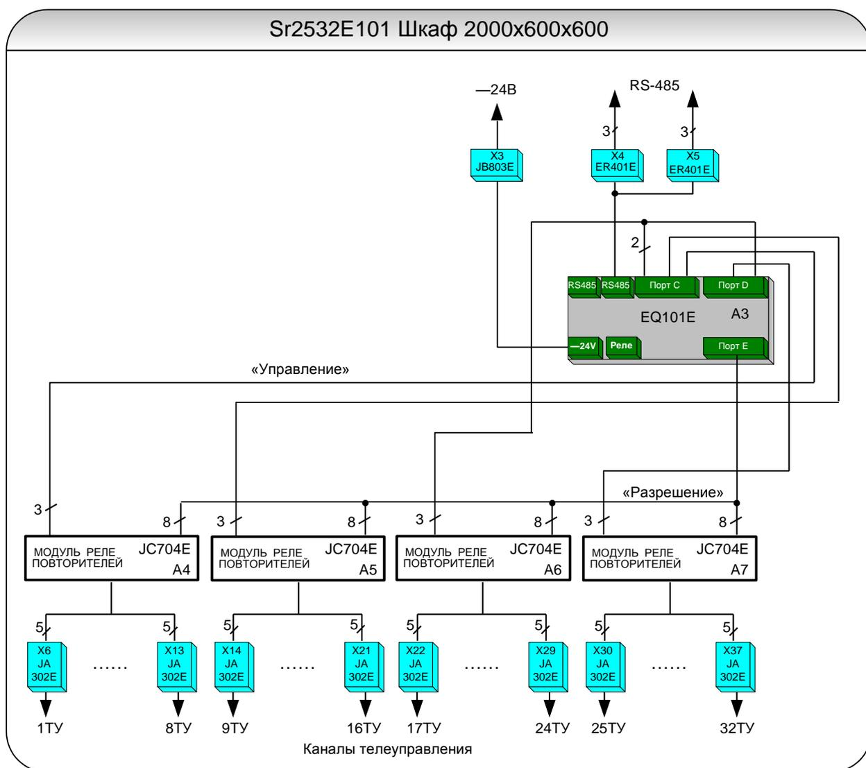
Рисунок 2 – Структурная схема блока SR2532E101
